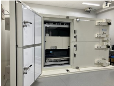
放射性物質の種類と放射エネルギーを測定できるホールボディカウンター
