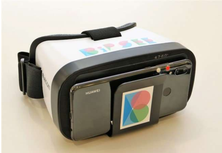
医療用VR「BIPSEE医療XR」。専用のスマートフォンをゴーグルにセットして使う
